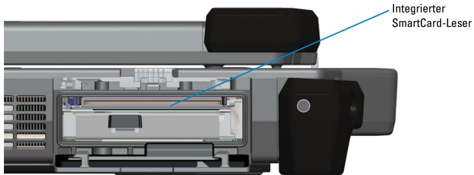
Die Smart Card wird vollständig eingeschoben, so dass die Schutzklappe geschlossen werden kann. Schieben Sie die Smart Card mit der goldenen Kontaktfläche zuerst und nach oben zeigend in den Smart Card-Steckplatz. Drücken Sie die Karte in den Schlitz, bis sie vollständig im Steckplatz sitzt.
