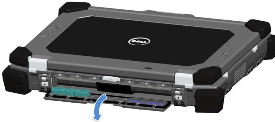
3. Drücken Sie die beiden Riegel der Akku-Freigabevorrichtung an der Unterseite des Computers nach außen.
