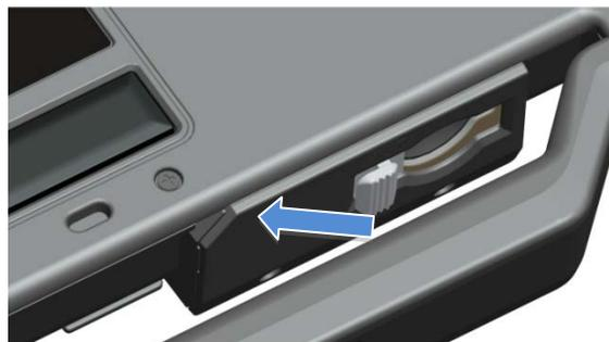
Die Secure Digital-Karte wird vollständig eingeschoben, so dass die Schutzklappe geschlossen werden kann. Schieben Sie die Secure Digital-Karte in den Schlitz, bis sie vollständig im Steckplatz sitzt. Zum Entfernen der Secure Digital-Karte drücken Sie auf die Kartenkante und das Lesegerät wirft die Karte aus.
