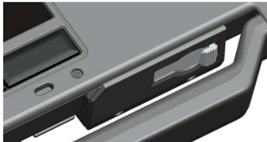
Um die Secure Digital-Klappe zu öffnen, schieben Sie den Riegel nach links hin auf. Schieben Sie den Riegel zum Schließen nach links, bis er einrastet.
